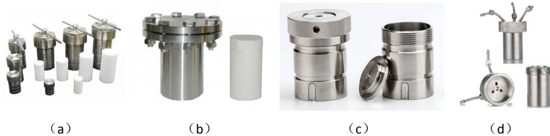
图 1 (a)(b) 为无泄压设计的水热釜 (c)(d) 为具有泄压设计的水热釜
