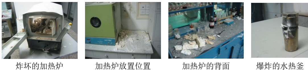
图 2 水热釜爆炸事故照片
